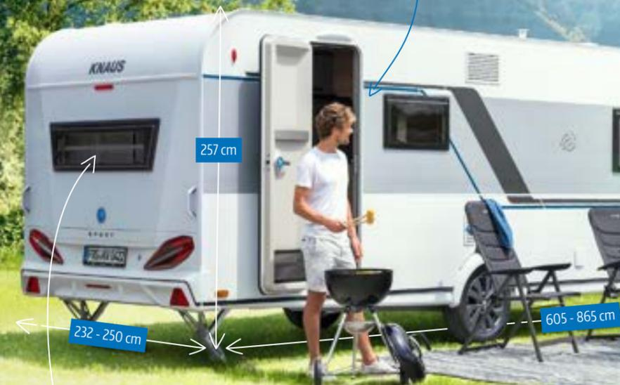
Die automotivem FoldXpand Heckkonstruktion mit bündig integriertem Heckleuchenträger sorgt für größeren Innenraum bei gleicher Fahrzeuglänge. Ergänzt wird der markante Look durch die Heckfenster in dynamischer Trapezform & weiterentwickelte CATEYE evolution Rückleuchten mit integrierter Ausfallkontrolle
