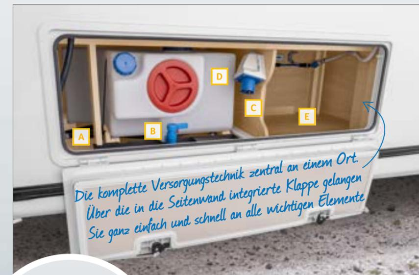
Die komplette Versorgungstechnik zentral an einem Ort. Über die in die Seitenwand integrierte Klappe gelangen Sie ganz einfach und schnell an alle wichtigen Elemente
