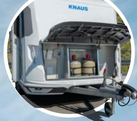
*Der Premium Gaskasten mit zentralem Servicemodul am Bug bietet Platz für zwei 11 kg Gasflaschen, sowie praktischen Zugriff auf wichtige Anschlüsse der Versorgungstechnik & zur Entleerung der Kassettentoailette*
