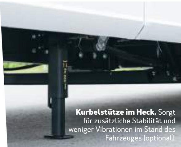
**Kurbelstütze im Heck.** Sorgt für zusätzliche Stabilität und weniger Vibrationen im Stand des Fahrzeuges (optional).
