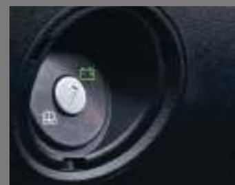
Mit dem optionalen Batterietrennschalter im Fahrerhaus kann die Batterieleistung geschützt werden.
