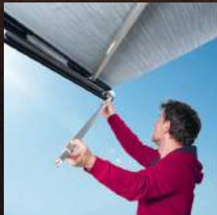
**Ausklappbar.** Die Stützen verfügen über ein Knickgelenk. Das vertikale Absenksystem verhindert Beschädigungen am Fahrzeug.
