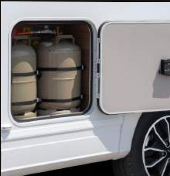
Einfacher Zugang zu den Gasflaschen durch den längs angeordneten Gaskasten.
