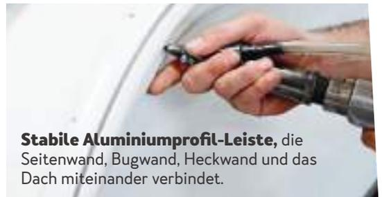
**Stabile Aluminiumprofil-Leiste,** die Seitenwand, Bugwand, Heckwand und das Dach miteinander verbindet.
