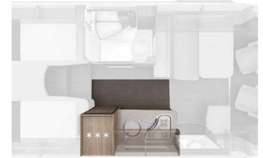
**Stauraumwunder.** Der Kühlschrank wird hier separat neben der Küchenzeile verbaut. Dadurch steht der komplette Küchenblock als Stauraum zur Verfügung und der Kühlschrank kann mit bis zu 142 Liter besonders groß ausfallen.
