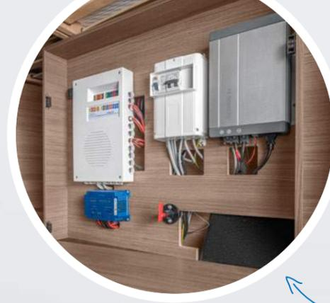
*Bestens organisiert! Dank der zentralen Positionierung der gesamten Fahrzeug-Elektrik, wie hier beim VAN TI in der Heckgarage sind alle wichtigen Elemente leicht zugänglich & übersichtlich angeordnet. Das spart Zeit im Wartungsfall*
