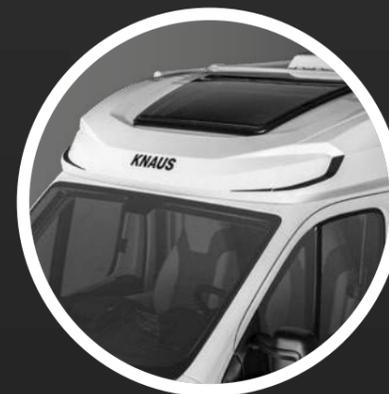
*Modernste LFI-Technologie (Long-Fibre-Injection) kommt beim VAN TT an der Dachhutze mit integrierter Isolation zum Einsatz. Dank des hierbei verwendeten faserverstärkten Polyurethans sind die Komponenten besonders leicht und gleichzeitig hochstabil sowie widerstandsfähig, selbst bei extremer Hitze und Kälte*
